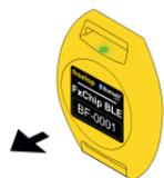
▶ **Activez votre FxChip BLE: Placez-le à la verticale et secouez-le horizontalement.** La led verte confirme que l'appareil est activé.
